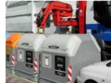
La familia de normas UNE-EN 840 sobre contenedores móviles para residuos reúne los requisitos de fabricación y seguridad necesarios que han de cumplir estos contenedores para un funcionamiento seguro y óptimo con los sistemas de elevación definidos por la normas UNE-EN para los diferentes vehículos de recogida. Es necesario, por tanto, que los contenedores utilizados por las empresas estén certificados conforme este estándar.
