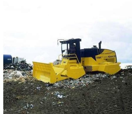
Las cabinas de las máquinas empleadas, palas y compactadores deben cerrarse de forma hermética, y deben disponer de sistemas de climatización que incorporen filtros de aire. En el interior de las cabinas los trabajadores poseen mascarillas o mascareras dotadas de filtros adecuados a los contaminantes gaseosos que pueden encontrarse en el vertedero, para su utilización en los casos en que sea necesario salir de la cabina.
