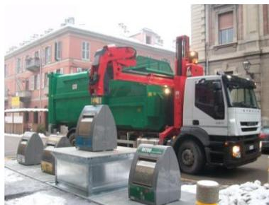
El vehículo de recogida puede ser un camión pluma mediante sistema manual o un vehículo con brazo articulado con sistema automático de recogida, en el que interviene un solo operario desde la cabina del vehículo. Los procesos de recogida coinciden con los descritos en el apartado de carga superior.
