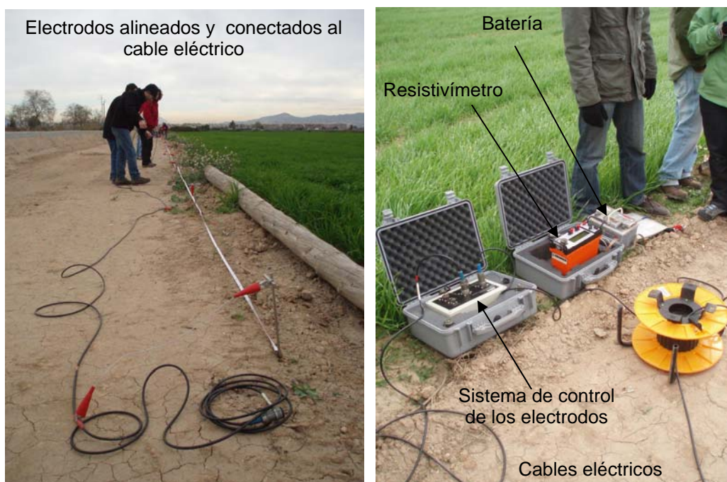
Figura 2.2. Elementos de un equipo básico de prospección eléctrica. Normalmente Los equipos modernos llevan el milivoltímetro y el amperímetro integrado en un mismo registrador llamado resistivímetro. En él también residen los programas de control "geométrico" de los electrodos para regular los distintos dispositivos de adquisición de los datos. Normalmente, el intercambio de las funciones de potencial/corriente de los electrodos está controlado por un dispositivo externo de relés.
