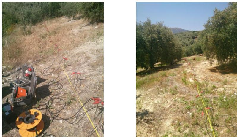
Figura 4.5 Vista parcial de los perfiles eléctricos P-2 y P-3 realizados sobre la zona más basal del deslizamiento.
