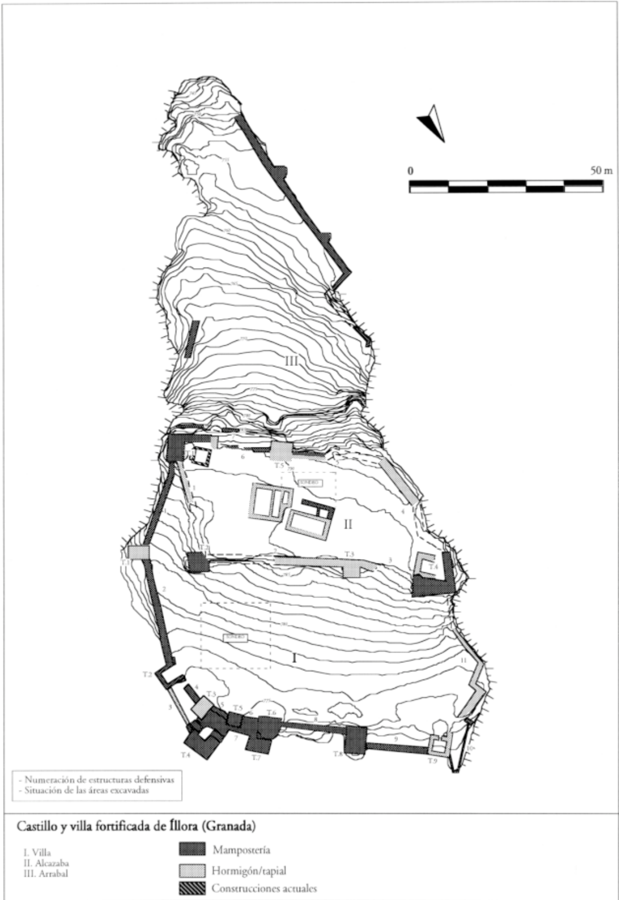
FIG. 1. Plano general del castillo de Illora, con indicación de la numeración de torres y sectores de la muralla y de la situación de los sondeos.
