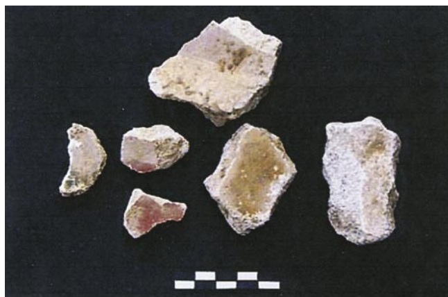
FIG. 5. Fotografía de algunas de las muestras analizadas. La imagen corresponde a muestras de estucos romanos localizadas en un relleno de amortización del sondeo estratigráfico V. Muestra 235. Unidad 703.
