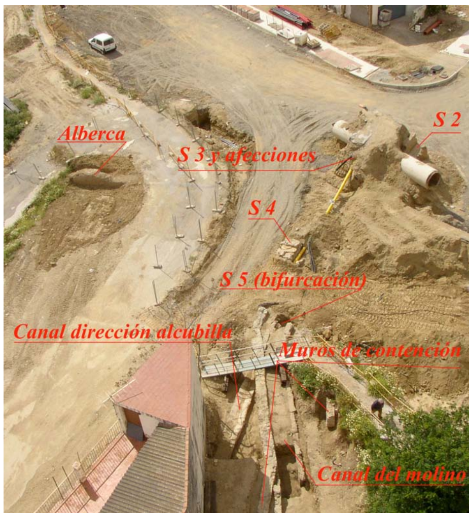
Lamina II. Perspectiva aérea de las áreas de afección así como de gran parte de los elementos documentados del acueducto.
