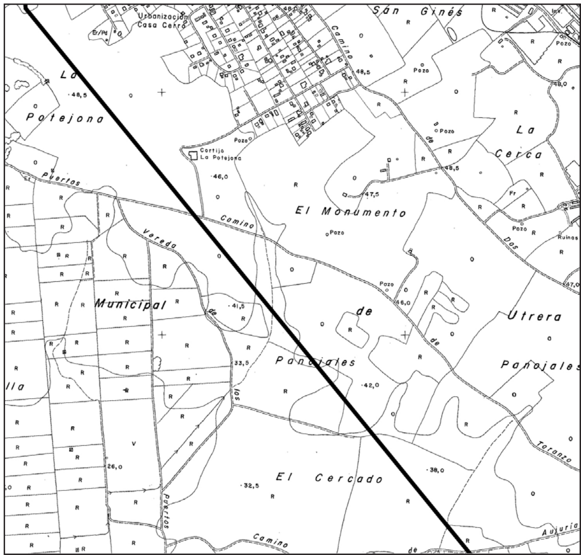
Figura 3. Plano en el que se observa la prospección desde el camino llamado "Aujuría", siguiendo el trazado de la línea eléctrica proyectada, hasta la intersección con la línea de alta tensión actual (vértice de inflexión de la línea proyectada).
