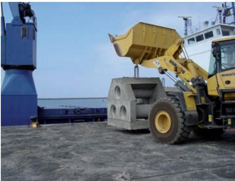
Transporte con pala excavadora hasta el costado del barco.
