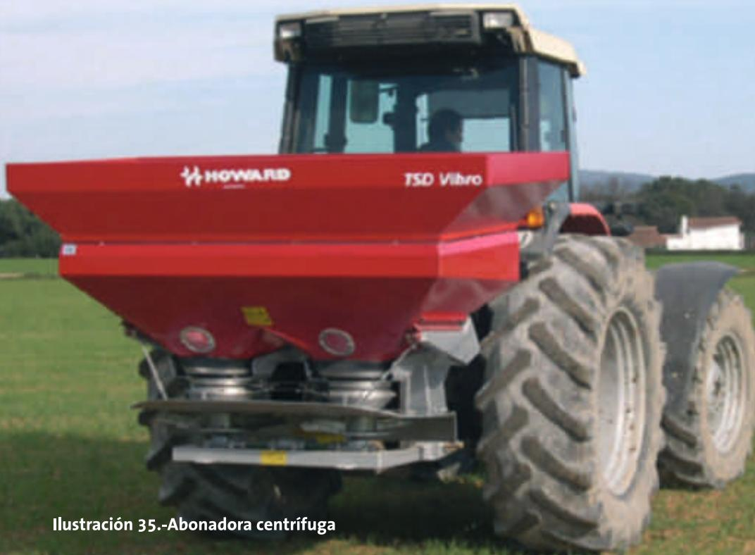
**Ilustración 35.-Abonadora centrífuga**
