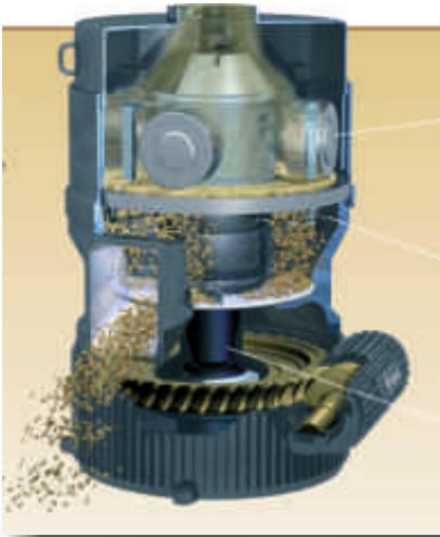
**Ilustración 32.-Prensa granuladora**
