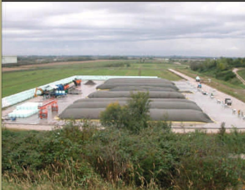
Ilustración 8.- Sistema pilas estáticas aireadas
