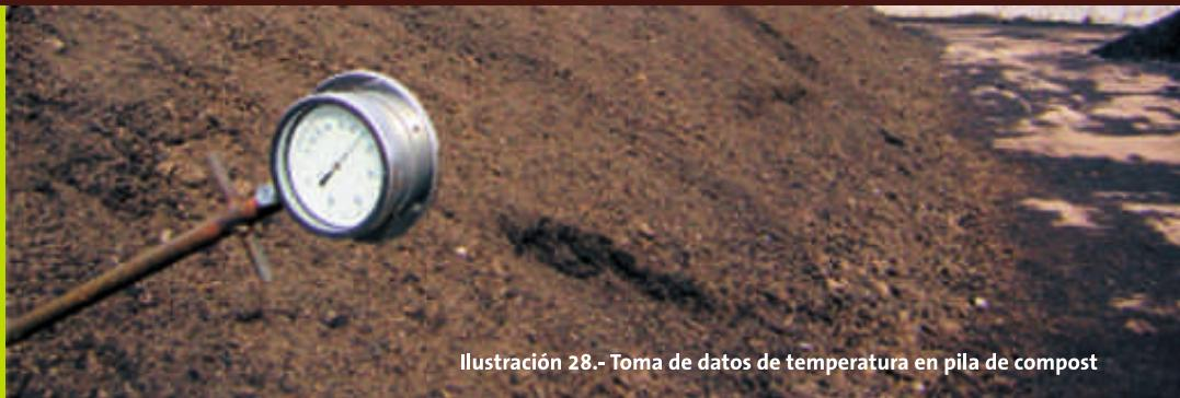
Ilustración 28.- Toma de datos de temperatura en pila de compost
