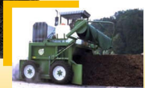
**Ilustración 18.- Volteadora autopropulsada**
