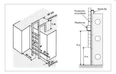
Las escalas fijas son un tipo de escalera que está anclada o soldada a una superficie vertical y sirve para acceder ocasionalmente a tejados, pozos, silos, chimeneas y otras zonas de acceso restringido.
