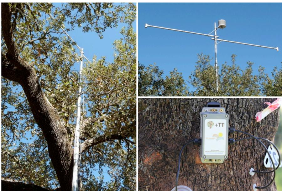
**Figura 7.** Parcelas de seguimiento fisiológico del arbolado de encina en la dehesa de los Pulidos (Puebla de Guzmán) de los propietarios D. López Mora (a) parcela (b) sensores de variables de copa (c) sensor de flujo de savia y dendrómetro digital. Fuente: Grupo ERSAF.
