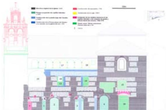
Fig. 16-B. Evolución arquitectónica del muro sur del edificio.
