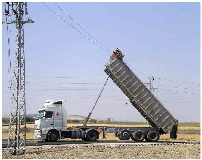
Imagen 2. Caja basculante del camión en contacto con la línea de 15 Kv. Se aprecia que solo hay dos cables ya que el tercero se rompió tras contactar.
