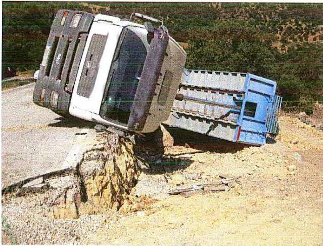
Imagen 2. El camión volcó al desplazarse hacia atrás sin control, cuando las ruedas traseras superaron el borde del talud. Se aprecian las dos grandes piedras que taponaron el portalón trasero y el desnivel producido por el deslizamiento de la carretera.
