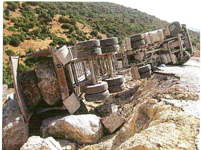
Imagen 2. El camión volcó al desplazarse hacia atrás sin control, cuando las ruedas traseras superaron el borde del talud. Se aprecian las dos grandes piedras que taponaron el portalón trasero y el desnivel producido por el deslizamiento de la carretera.
