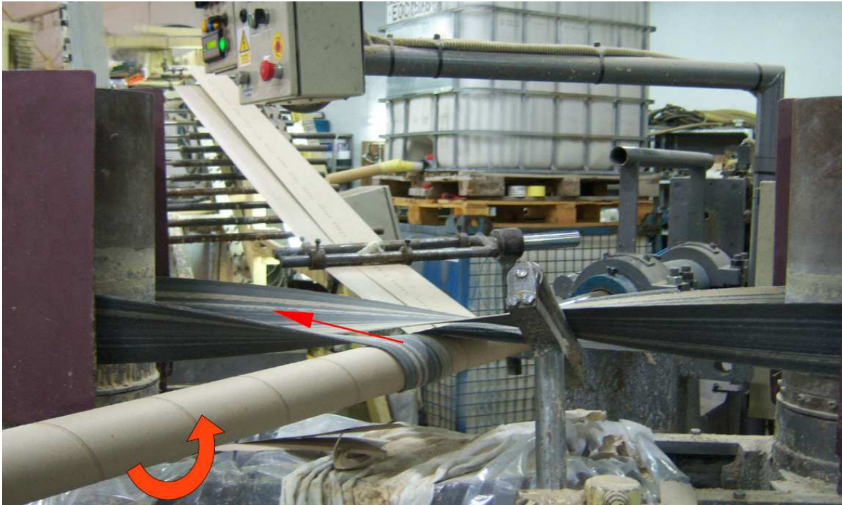
Imagen 3. Máquina espiraladora. El movimiento giratorio del eje del mandril y la correa van conformando el rebobinado del tubo de cartón.
