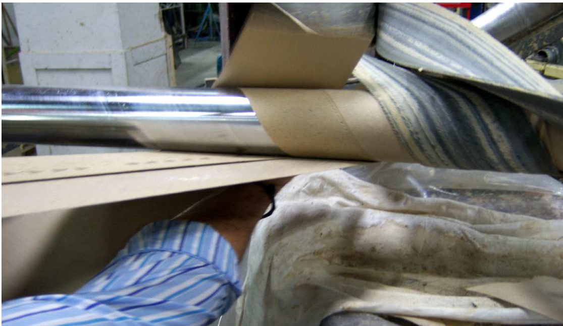
Imagen 5. Simulación del accidente. Al acercarse la banda de papel rota hacia la espiraladora la mano es atrapada entre la correa y el eje del mandril.
