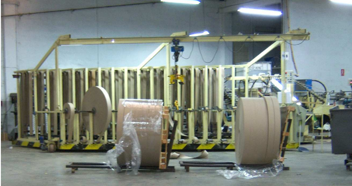
Imagen 1. Desbobinador de papel, donde comienza el proceso de fabricación.
