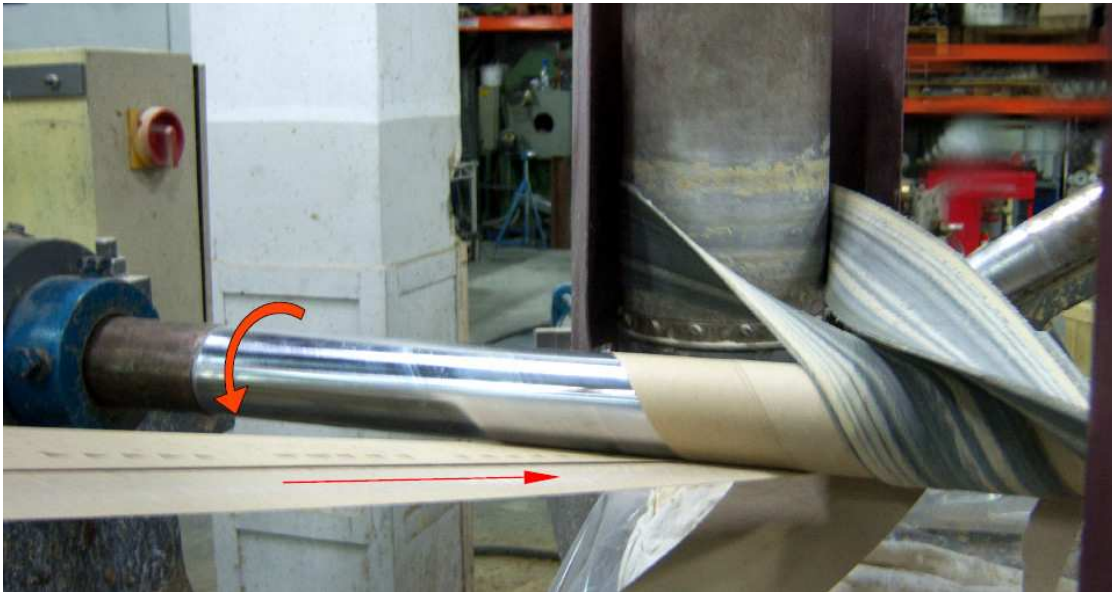
Imagen 4. Detalle de la barra metálica o mandril que hace de molde. La correa de bobinado rebobina el papel para la formación del tubo de cartón.
