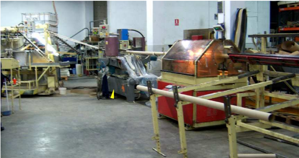
Imagen 2. Línea de producción de tubos de cartón. Los equipos de trabajo de izquierda a derecha son: encolador, espiraladora y cortadora.
