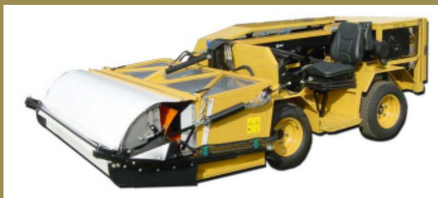
Barredora de aceitunas semejante a la utilizada. Diseñada para recoger las aceitunas que se encuentran en el suelo y trasladarlas al lugar deseado.
