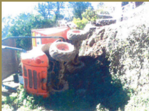
Derrumbe del talud y estado en que quedó el vehículo tras sufrir el vuelco.
