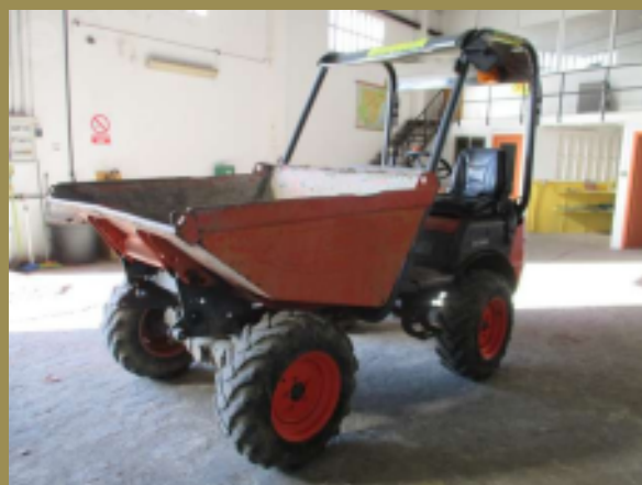
Autovolquete que utilizaba provisto de estructura antivuelco y cinturón de seguridad.
