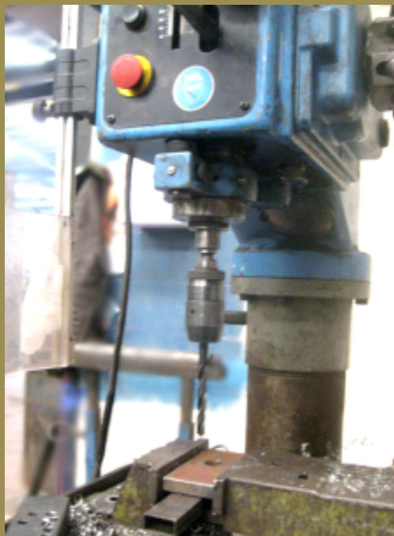
Para perforar la pieza metálica había que sujetarla con una mordaza fija sobre la mesa de trabajo.
