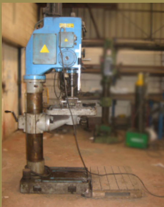
Taladro de columna que originó el accidente.
