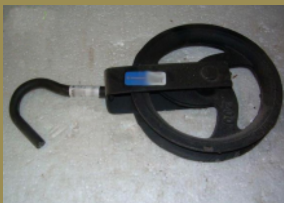
Polea utilizada para el descenso de la saca
