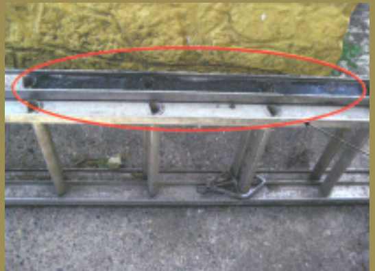
Escalera implicada en el accidente. En el lateral se aprecia el fognazo que deja el arco eléctrico.
