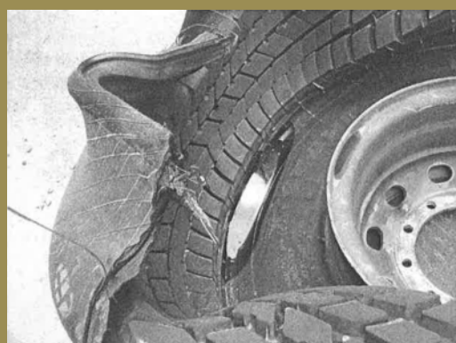
Estado de la rueda de la grúa al estallar por consecuencia de la segunda descarga.
