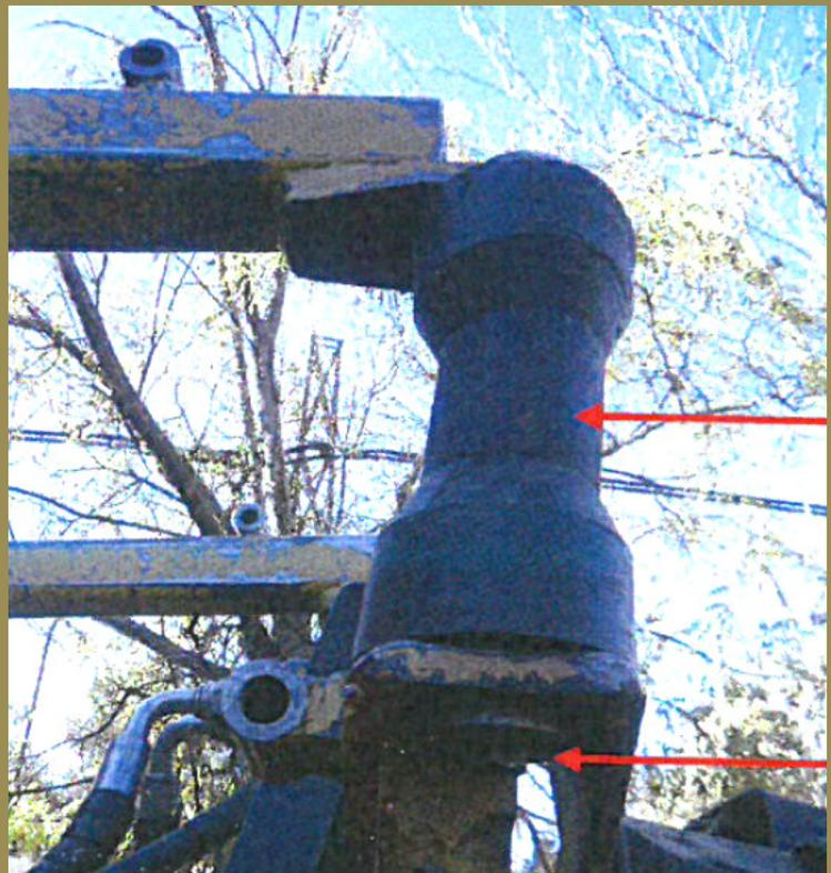
Pieza sobre la que realizaban el apriete del tornillo y sujeción con llave grifa. Arriba el silentblock y abajo la tuerca.
