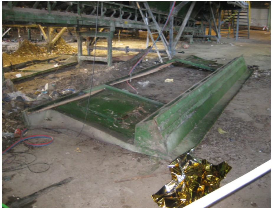
Chapa que cayó desde la plataforma y arrastró al trabajador que finalmente falleció por aplastamiento
