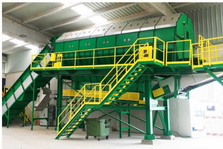
Tromel similar al que produjo el accidente. Indicado para la criba por rotación de residuos sólidos urbanos
