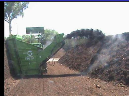
**SISTEMA ABIERTO** (pilas o meseta volteadas). Tipo de sistema viene condicionado por volumen de materia prima a compostar. El sistema más simple y asequible, formación de pilas o mesetas de unos 2-3 metros de altura.
