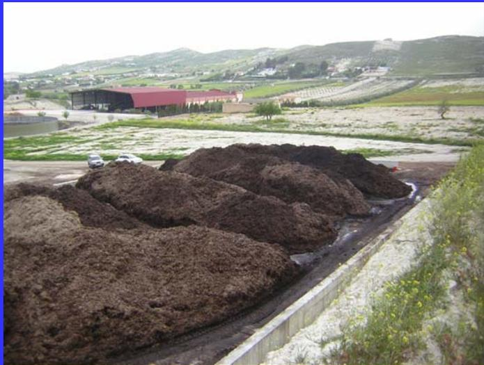
El compostaje es un **proceso biológico aerobio**, mediante el cual los microorganismos, actúan sobre la materia orgánica biodegradable, bajo **condiciones de aireación, humedad y temperatura controladas**.
