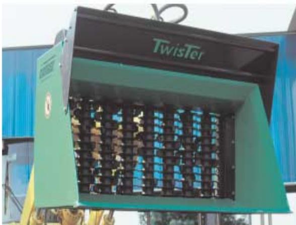
**Figura 4.20** Detalle de cuchara separadora
