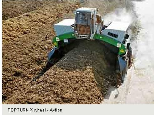
**Rendimiento:** La TOPTURN X53 WHEEL es una volteadora de mayor potencia para altos rendimientos y poco espacio ocupado. Un rendimiento de hasta 2000 m<sup>3</sup>/h es perfectamente posible, la máquina puede trabajar con un ancho máximo de trabajo de 5,0 m y una altura máxima de la pila de 2,4 m.
