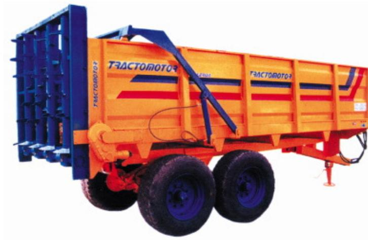
El remolque esparcidor de estiércol de Tractomotor Industrial viene equipado con cilindros verticales.
