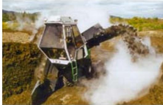
Actualmente, es la volteadora de compostaje en meseta con el rendimiento más alto - voltear entre 1000 y 1500 m<sup>3</sup>/h es perfectamente posible - puede trabajar con un ancho de extracción de 2 m y una altura de la meseta de 3,5 m.
