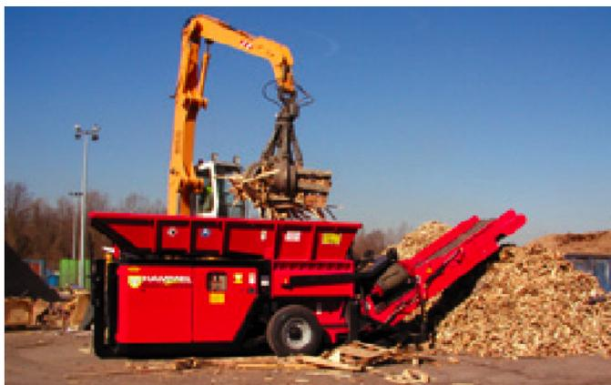
Este pre- triturador sirve para reducir de tamaño materiales extremadamente difíciles, como madera de desecho, tocones, residuos verdes, etc. Trabaja con dos rotores (ejes) de velocidad lenta.
