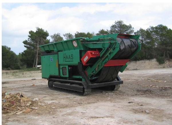
El triturador primario de dos ejes Haas HDWV está diseñado para triturar madera, colchones, voluminosos, traviesas, RSU, RSI, raíces, tambores de cables, etc.
