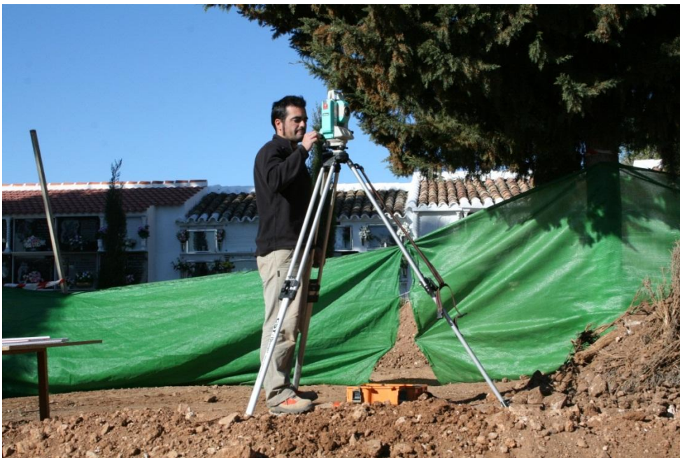
Lámina. Detalle del equipo técnico con la estación Total de topografía con la toma de puntos para realizar el levantamiento topográfico.
