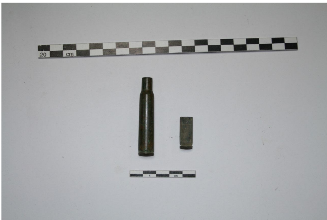
Detalle de una vaina para fusil de máuser 7m/m y vaina para pistola de 9 mm. Fábrica Pirotecnia de Sevilla.
