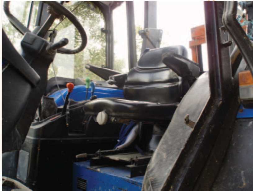
Foto3. Detalle del interior de la cabina en la que se puede apreciar la no dotación del cinturón de seguridad y la no existencia de puerta.
