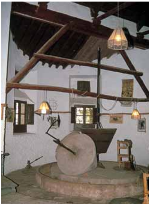
Empiedro y diferentes sistemas de prensado en la nave del molino, dos prensas de capilla al fondo –una de ellas montada– y prensas a sangre.
