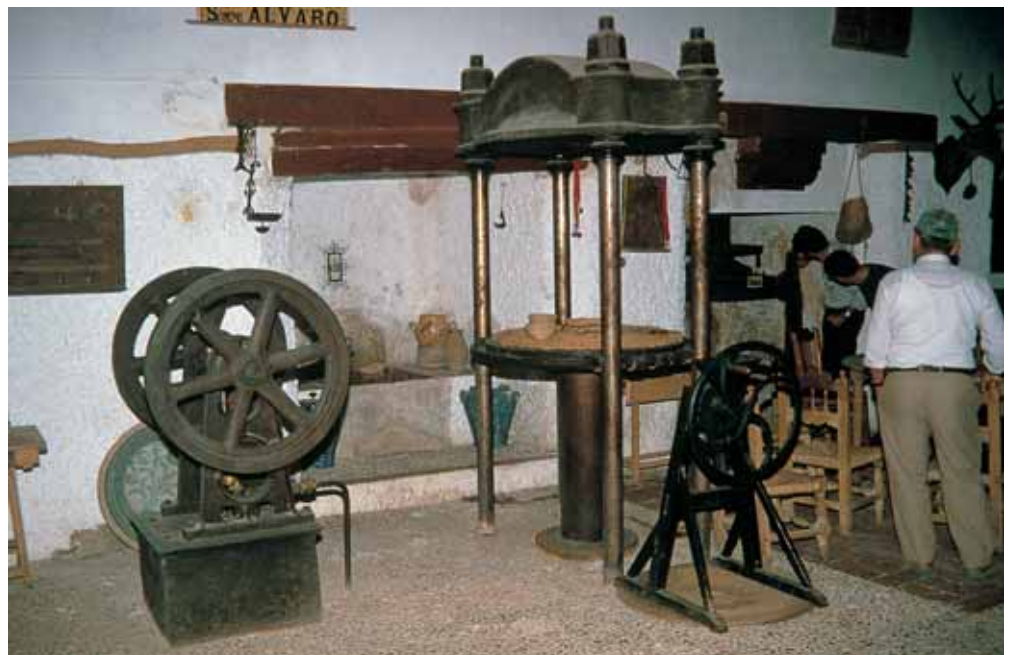
Empiedro y diferentes sistemas de prensado en la nave del molino, dos prensas de capilla al fondo –una de ellas montada– y prensas a sangre.
