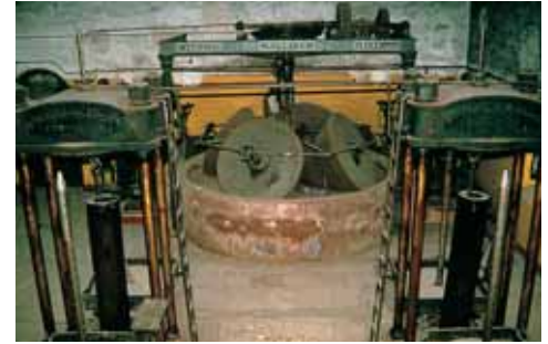
Detalle del empiedro y las prensas hidráulicas situadas en la nave de molino.
