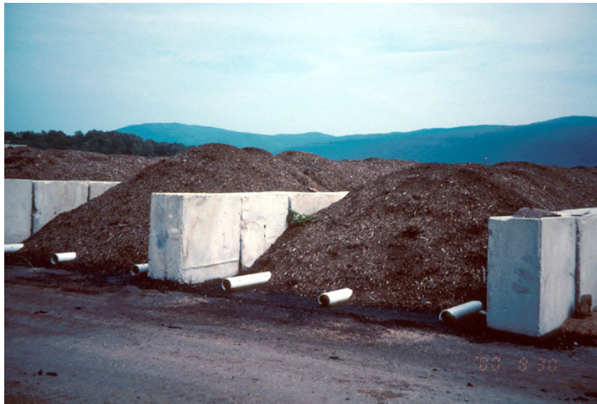
Figura 3.2. Detalle de pilas estáticas con aireación pasiva.
