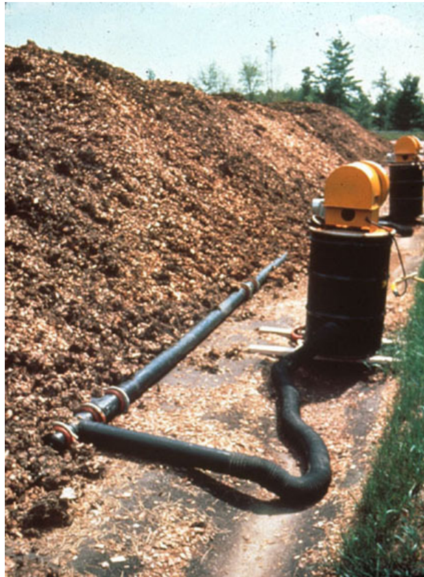
Figura 3.3 Detalle de pilas estáticas con aireación activa
