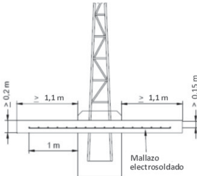
Figura 4.- Solera CTI con mallazo electrosoldado.
