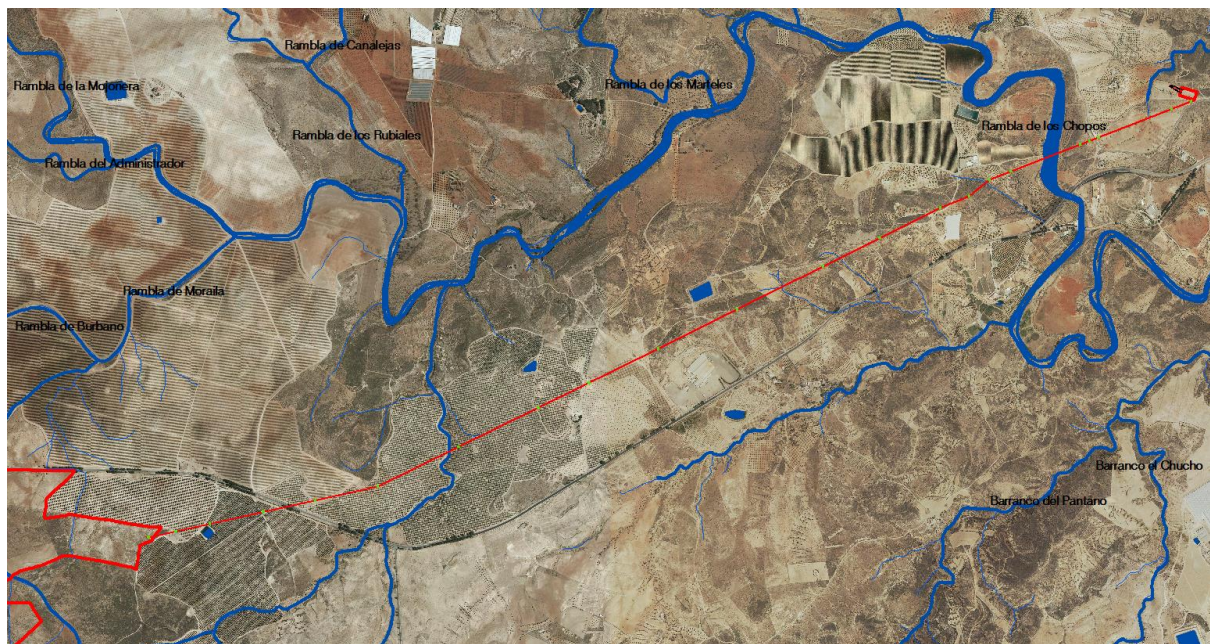
Imagen 9. Ramblas afectadas por el trazado de la línea eléctrica de evacuación de la PSF. Fuente: REDIAM
