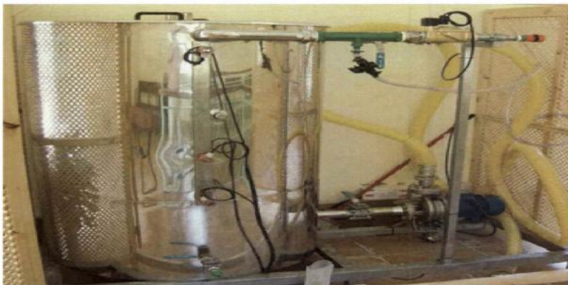
Fotografía 4. Sistema de limpieza en circuito cerrado.
