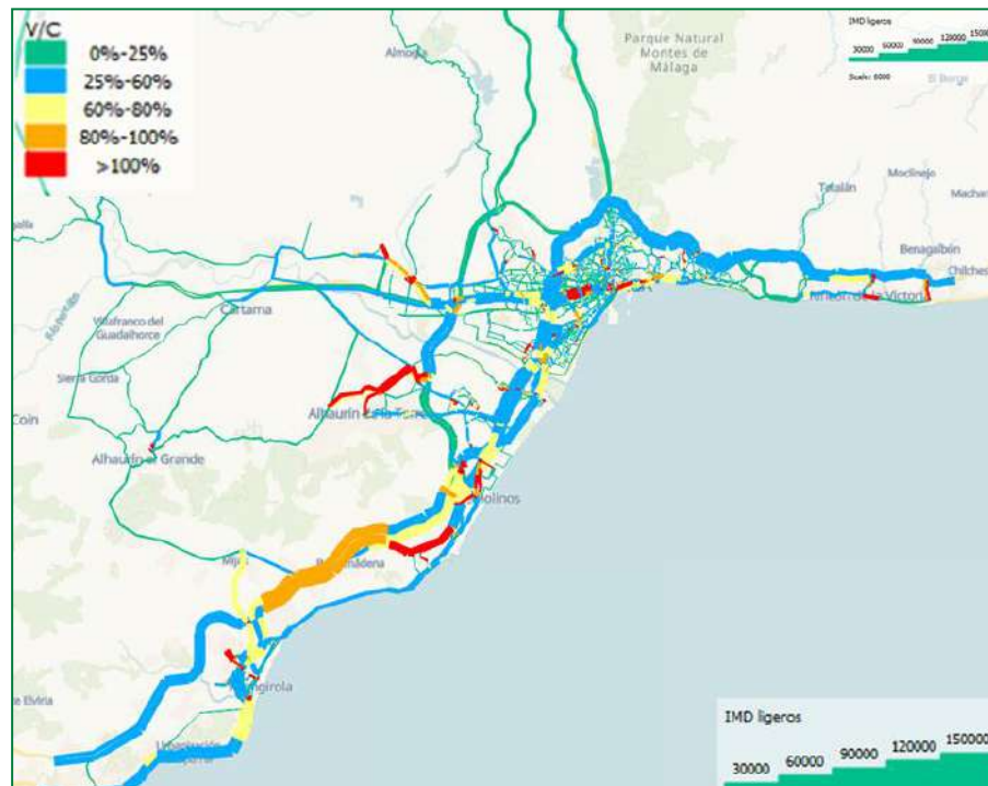
Figura 37: Detalle del análisis volumen de demanda/capacidad en el Área Metropolitana de Málaga en verano.
