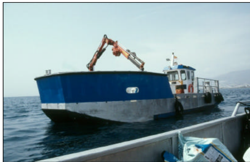
Foto 11: Embarcación auxiliar de instalación de jaulas de cultivo.
