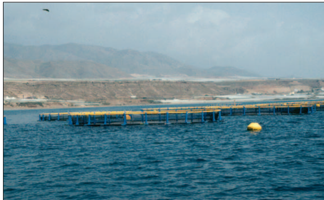
Foto 3: Instalación de acuicultura marina en jaulas flotantes.
