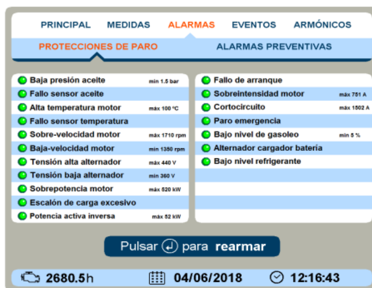
Pantalla de alarmas de protecciones de paro del grupo electrógeno
