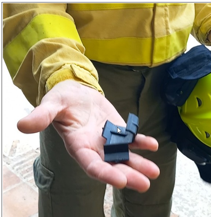
Fotografía 4: acople de linterna roto.
