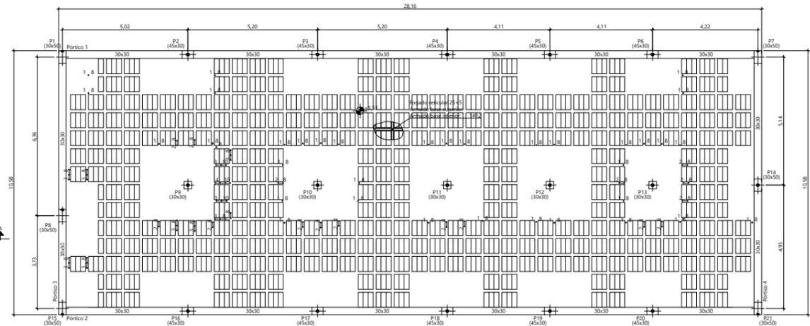
FORJADO DE CUBIERTA. PLANTA DE REPLANTEO Y ARMADO DE PUNZONAMIENTO
