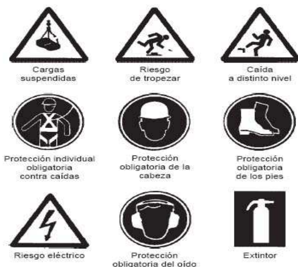
Cuadro 1. Señales normalizadas en forma de panel
