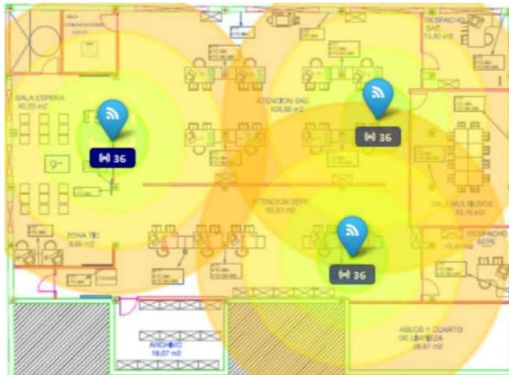
Planta Baja: Simulación AP-SEDE SAE en 5 GHz.
