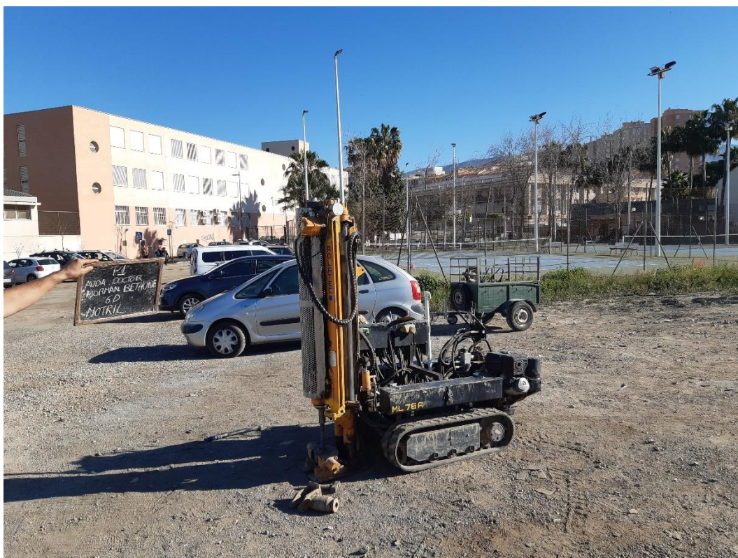
ENSAYO DE PENETRACIÓN DINÁMICA CONTINUA Nº 1
