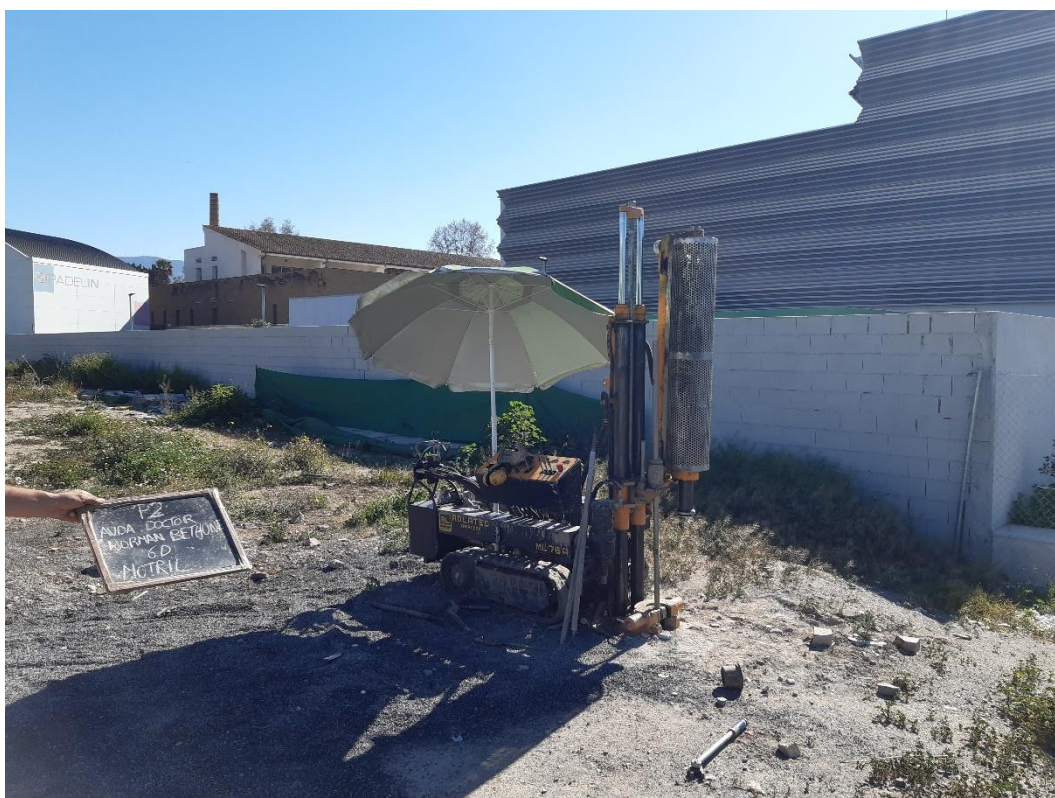
ENSAYO DE PENETRACIÓN DINÁMICA CONTINUA Nº 2
