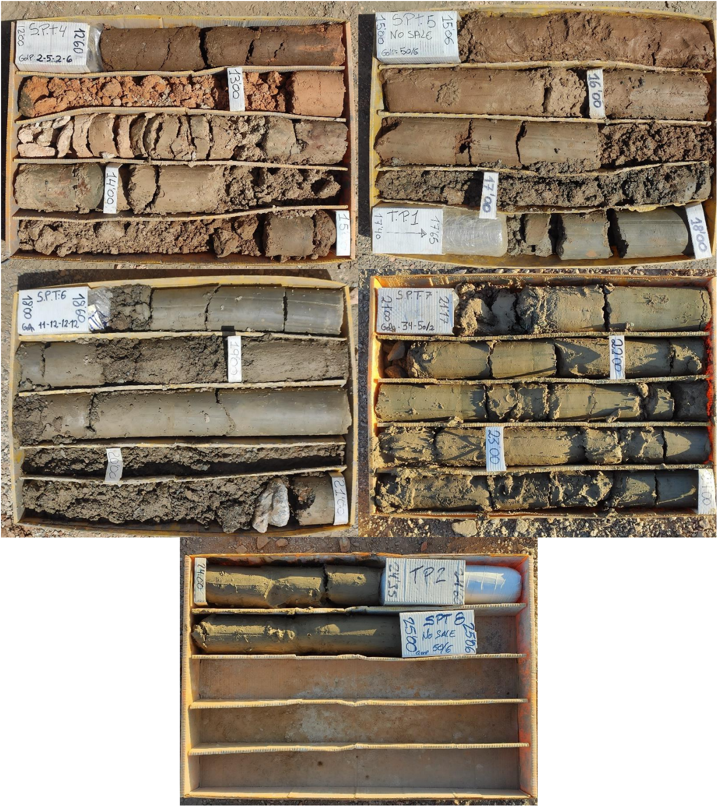
CAJAS DE SONDEO N° 2 (12.00 – 25.06 m)
