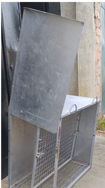
Imagen 2: Detalle de jaula de compresión con apertura de una de las puertas de guillotina comprimiendo la mitad de la profundidad de la jaula.
