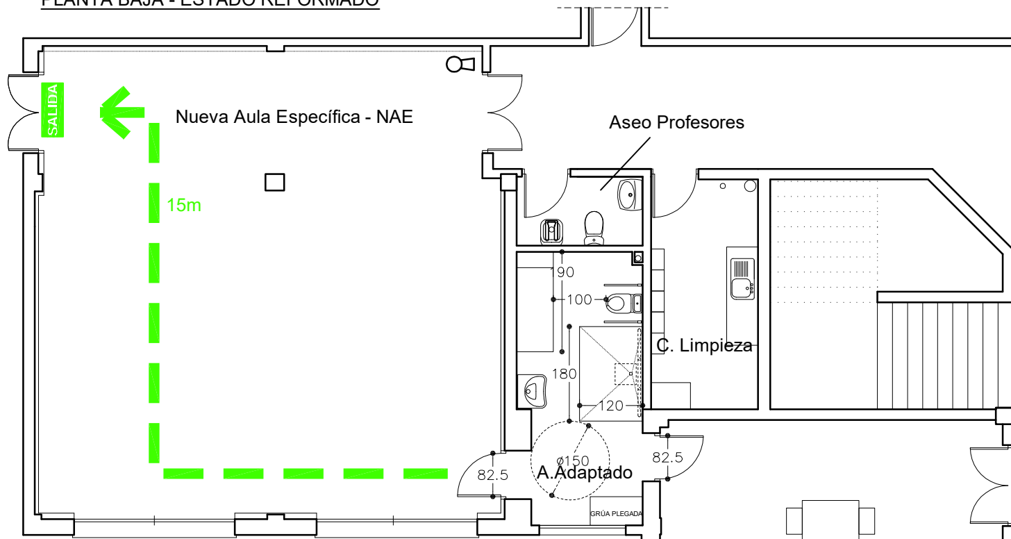
ESQUEMA DE ALTURAS ASEO ACCESIBLE
