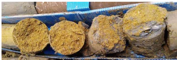
Tramo más arenoso y cementado
