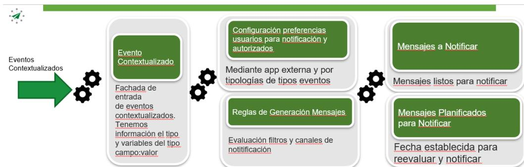
Figura: Estructura módulo de reglas de generación de mensajes
