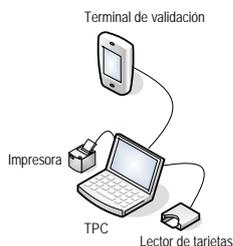
Ilustración 1 Elementos de un TPC
