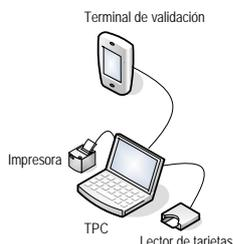
Ilustración 1 Elementos de un TPC
