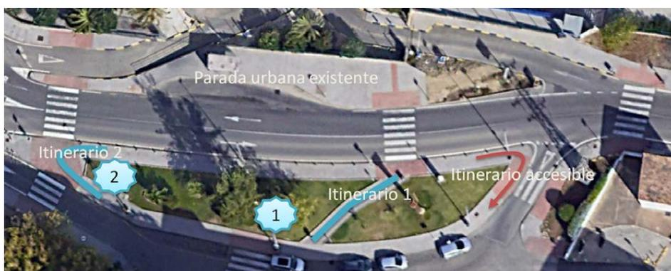
**Ilustración 6 Vista con ubicación de tramos de escaleras 1 y 2, e itinerarios afectados**
