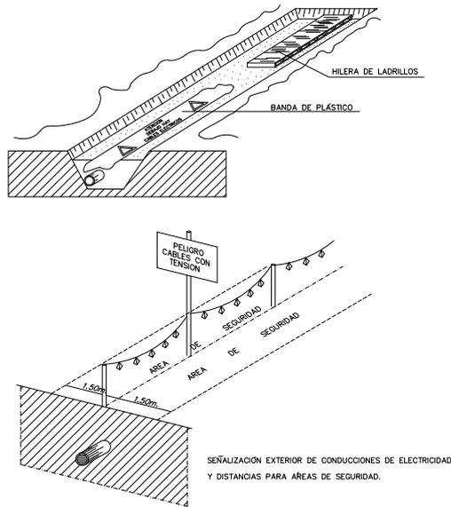
DISTANCIAS MÁXIMAS DE SEGURIDAD RECOMENDABLES EN TRABAJOS DE EXCAVACIÓN SOBRE CONDUCCIONES DE GAS Y ELECTRICIDAD.
