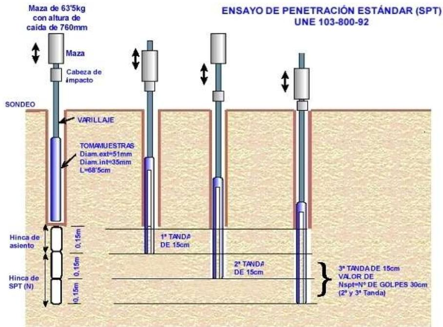
Los ensayos de Penetración SPT se utilizan en Geotecnia para correlacionar diferentes parámetros resistentes de los suelos. Estos ensayos determinan la resistencia de los suelos a la penetración de un tomamuestras partido, permitiendo obtener muestras alteradas de suelo dentro de un sondeo para su identificación, y proporcionando a su vez información sobre la variabilidad y rigidez del suelo.
