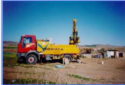
Las perforaciones se realizan con una sonda de avance hidráulico montada sobre camión o con motricidad autónoma (según las necesidades y características del estudio) dotada de castillete o torre de sondeo y bomba de lodos.
