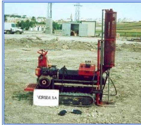
La resistencia a la penetración se define como el nº de golpes requerido para hacer avanzar el penetrómetro una longitud de 20 cm designándose a este valor como  $N_{DPSH}$ , representándose los resultados en gráficos que reflejan los diferentes golpes obtenidos en función de la profundidad. El ensayo se da por terminado cuando se alcanza el rechazo, que fijamos en un valor de  $N_{DPSH} = 100$  golpes.
