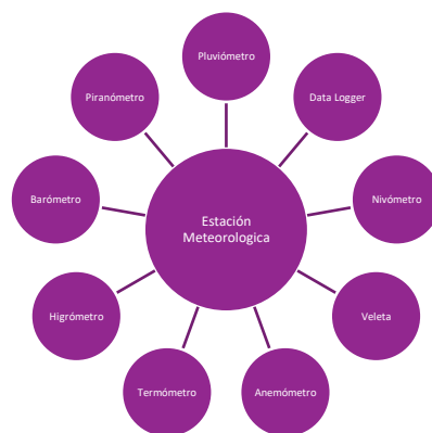
Ilustración 2. Elementos de la estación meteorológica.
