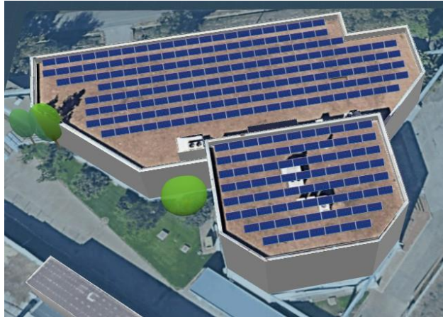
Ilustración 66. Distribución de los módulos fotovoltaicos (1).
