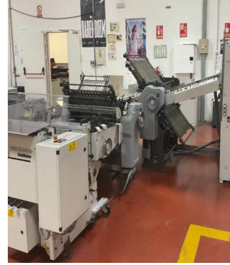
Ilustración 39 Plegadora 4 estaciones Planta 0 Taller Imprenta
