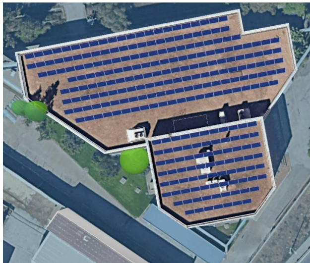
Ilustración 67. Distribución de los módulos fotovoltaicos (2).
